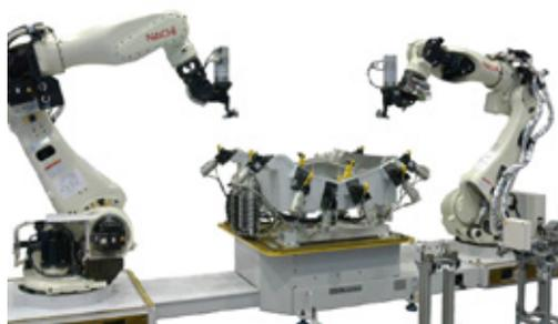
世界に先駆けて開発した板金曲げ加工用「ロボットヘミングシステム」
